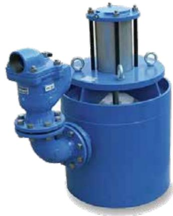
Selbsttätige ERHARD-Belüftungs-Tellerventile werden in Talsperren-, Fernwasser- und Turbinenleitungen eingebaut. Sie schützen die Leitungen vor hohem Unterdruck, wie z.B. bei schnellen Abschaltvorgängen, Schnellentleerung oder Rohrbruch entstehen kann.
